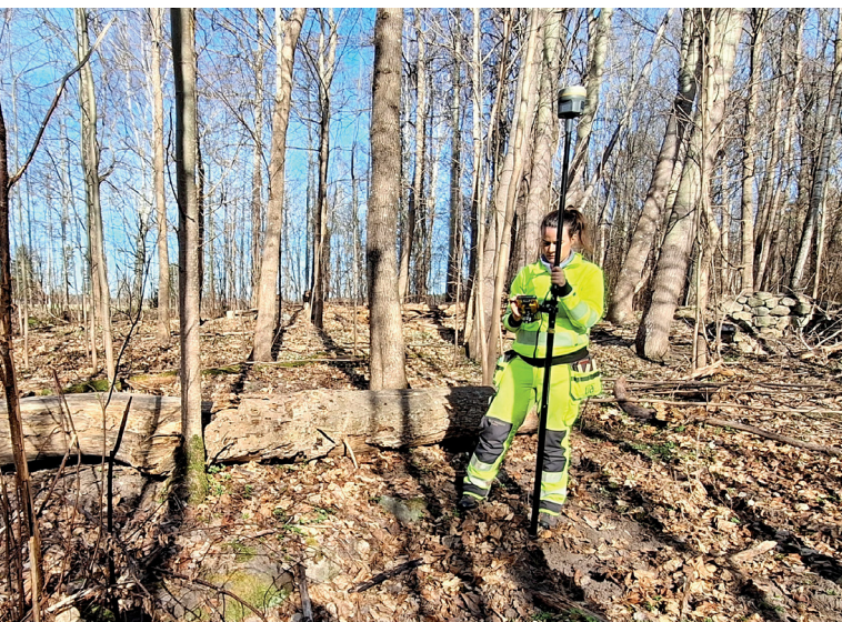
Figur 4. Inmätning med RTK-GPS inom UO 1.
